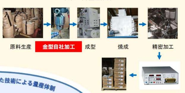
原料生産 → 金型自社加工 → 成型 → 焼成 → 精密加工 → 検査 → 出荷
